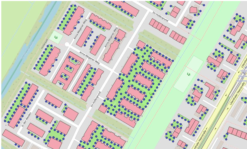
Abbildung 55: Darstellung der Platzierung der EWS auf den Grundstücken für ein Beispielgebiet: Platzierungsbereich auf den Grundstücken (hellgrün); Sondenstandorte (blaue Punkte)
